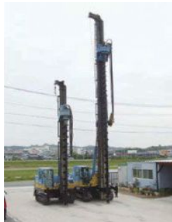
写真1. スーパーロックEX施工機 左: 20t級 右: 35t級
