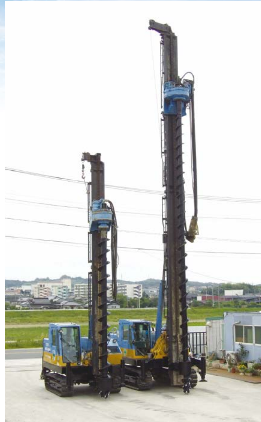
スーパーロックEXα施工機 左20t級 右35t級
